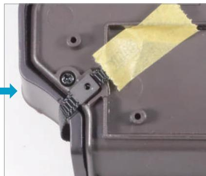
使用膠帶暫時固定 68-C 的前端在 68-A 的背面。將一個 68-D 對齊 68-A 的 U 字形，使 68-A 和 68-D 的螺絲孔對準，並使用錐子等工具在 68-C 上穿孔。
