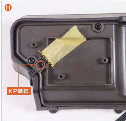
使用0號十字螺絲起子，以 **KP 螺絲** 固定。將多餘的 **68-C** 使用剪刀等工具沿著虛線剪掉，並與膠帶一起移除。
