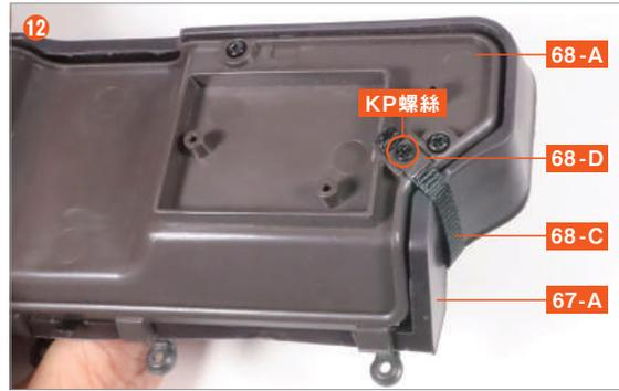
與步驟 9~11 相同方式，將另一側的 **68-C** 前端，沿著 **67-A** 的側面，將其繞到 **68-A** 的背面，確保不鬆動。以另一個 **68-D** 壓住並穿孔，然後使用0號十字螺絲起子，以 **KP 螺絲** 固定。將多餘的 **68-C** 使用剪刀等工具剪掉。
